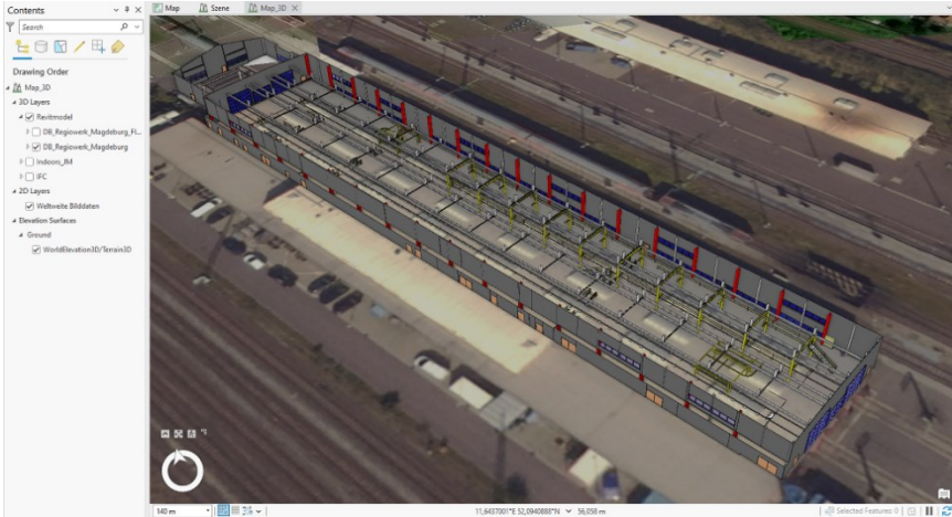
Abbildung 3: 3D-Modell (LoD 200) des DB Regio Werks in Magdeburg im Revit-Format. Die Visualisierung erfolgt in ArcGIS Pro
